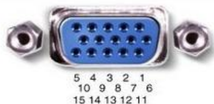
图 2-3 控制器 DB15 插头
