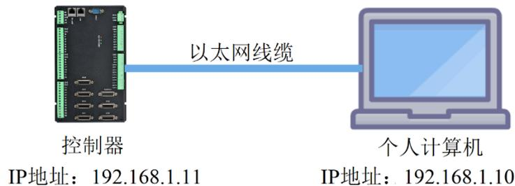
控制器也可以通过以太网电缆连接到交换机上，通过交换机与其他设备相连，实现多点连接，控制器最大支持三个链接通道。示意图如下：
